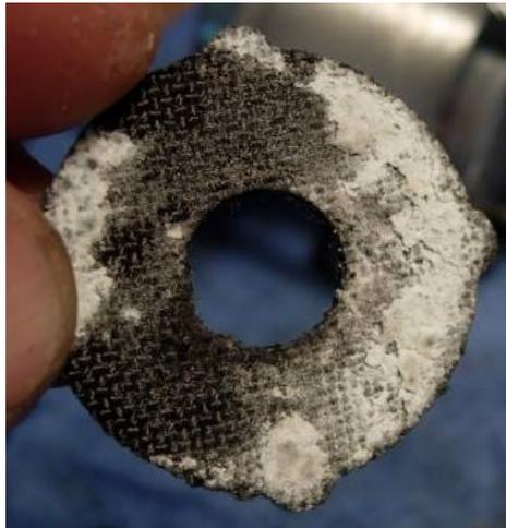
In alle Multirollen dringt durch den Spalt zwischen Oberkante der Spule und Unterkante des Rahmens Wasser in das Getriebe ein und kann in die Bremsscheibe(n) eindringen. Dieses führt unweigerlich zu Salzkristallbildung und zerstört die Scheiben wenn dagegen nichts gemacht wird.
