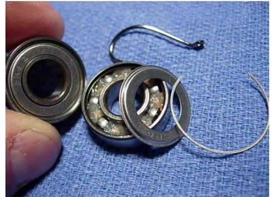
Öffnen eines Lagers mit Sicherungsring
