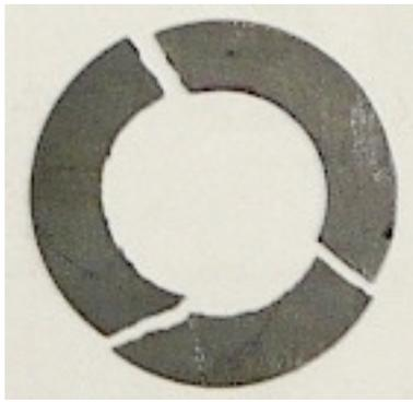
Dartainium Bremsscheiben (Shimano) können beim Zudrehen der Bremse brechen wenn der darüber oder darunter steckende Metal Washers nicht genau plan ist. So mir mal beim Drill eines strammen AJ passiert.... Sofort war die Bremskraft weg. Seitdem nur noch Carbon!
