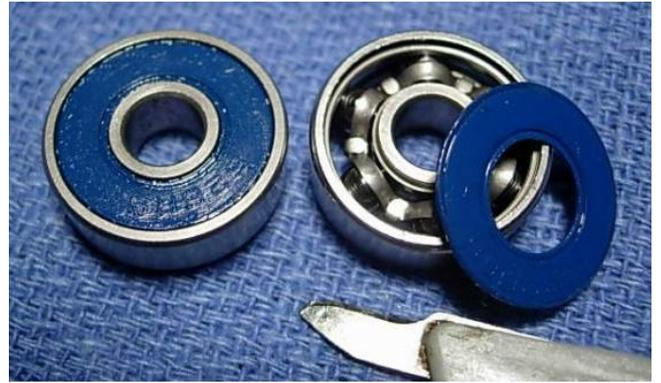
Öffnen eines 2RS Kugellagers. Vorsichtig ca. 0,5mm einstechen und den Deckel mit Gefühl abheben. Wie zu sehen ist das Lager werksseitig mangelhaft gefettet. Bei geschlossene Metaldeckel wäre das nicht zu sehen...
