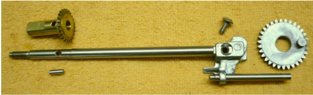
Die weiteren Getriebeteile. Exenterrad, Hubachse mit Slide mit eingesteckter Führungsstange gegen Verwindung des Slide. Spulenaufnahme mit Sicherungsstift
