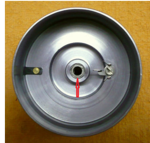
Hubstange wird in einem Kugellager geführt
