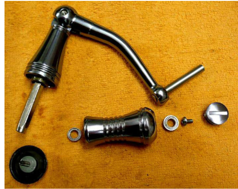
Der Kurbelknauf ist aus Metall. Gelagert auf zwei Kugellager. Das zu starke seitliche Spiel des Knaufs mit einer Passscheibe justiert.
