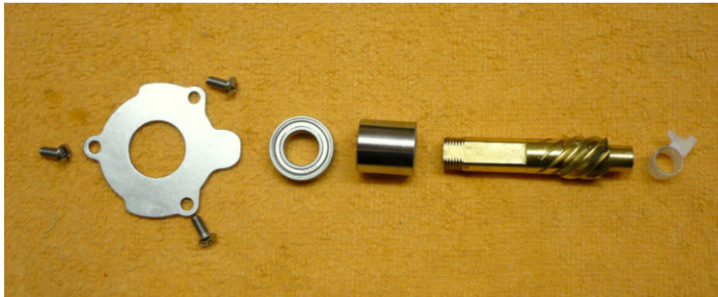
Alle Teile gleich (die Distanzscheibe ist auf dem Bild der Zalt Arc nicht mit abgebildet) Bei einer starken Meeresrolle muss das Ritzel beidseitig gegen Verwindung kugellagert sein! Die untere Plastebuchse ist ein No-Go.
