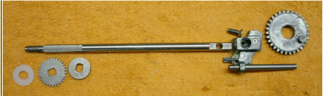
Exenterrad, Hubachse mit Slide mit eingesteckter Führungsstange gegen Verwindung des Slide. U-Scheibe, Ratschenrad, Distanzscheibe
