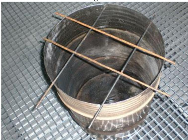
**Schritt 5:** Um den Räucher-Prozess genau überwachen zu können, muss nur noch ein Thermometer eingebaut werden. Hierfür einfach ein Loch bohren, das ganze wieder entgraten und abschleifen und schon ist das Ding drin. Am besten auf Höhe der Fische anbringen.
