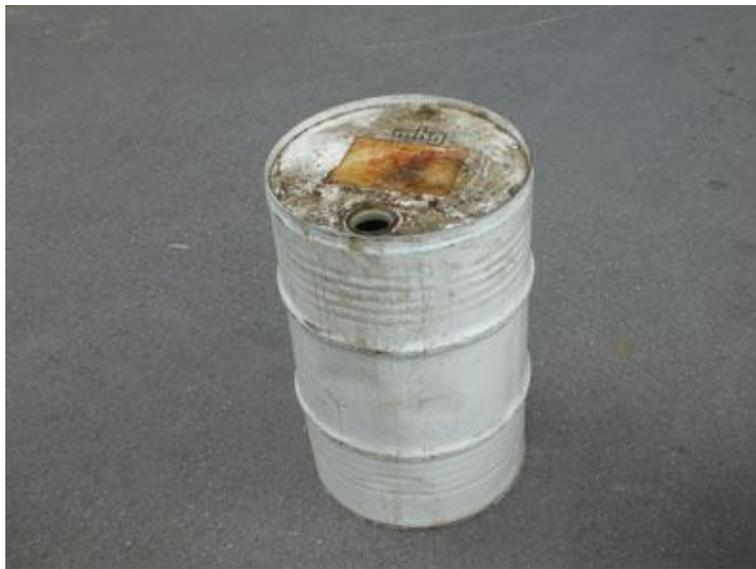
**Schritt 1:** Entfernen der Oberseite, vorsichtshalber mit einer Eisensäge, mit einer Flex kanns durch den Funkenflug zu Verpuffungen kommen.
